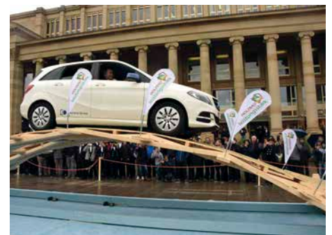
Der Aufbau und die Belastbarkeit der Da Vinci-Brücke zog viele Zuschauer an.
