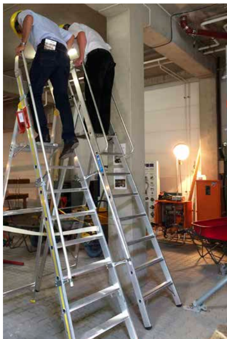
Begutachtung von Prototypen der leichten Plattformleitern im Praxiszentrum der BG BAU in Nürnberg als eine der Maßnahmen für mehr Sicherheit. Foto: „BG BAU / Rahming“
